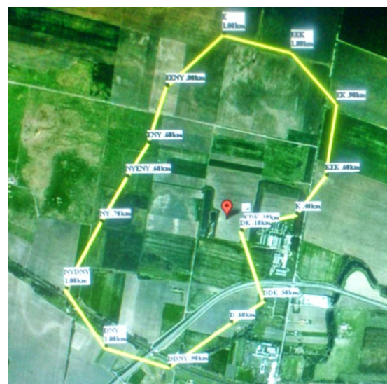
4. ábra: Dunakeszi hulladéklerakó (baloldal) és egy biharkeresztesi sertéstelep (jobboldal) esetében számított zavaró szag hatásterülete
