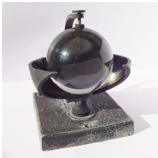
2. ábra: JUNKALOR gyártmányú napfénytartammérő
