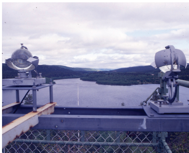
5. ábra: Napfénytartammérők a Sarkkörön készen arra, hogy 24 óra napfénytartamot regisztráljanak
