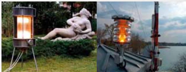
3. ábra. (a) Az első szériában alkalmazott viharjelző lámpák egyike. A villogó fényt forgómotor hajtotta tükör biztosította, (b) modern ledes viharjelző lámpa az Obszervatórium tetején.
