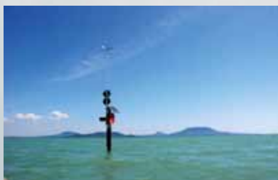
4. ábra. Automata szélműszer Szigliget és Balatonmária között. A napelelről működő berendezés a LIFE project keretében készült, később OMSZ műszerekkel lett felszerelve és az RSOE rádiós rendszere gyűjti az adatokat.
